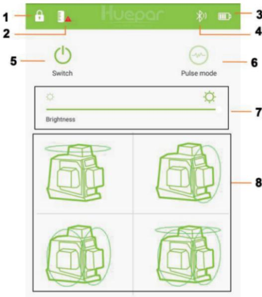
1. Интеллектуальная статус маятникового замка: когда лазерный прибор включен в ручном режиме, отображается значок 1, а при включении в режиме самовыравнивания значок 1 исчезает.
