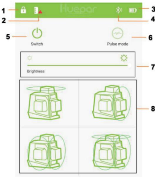
1. État de verrouillage intelligent du pendule: lorsque l'outil laser est allumé en mode manuel, l'icône 1 s'affiche; lorsqu'il est activé en mode de mise à niveau automatique, l'icône 1 disparaîtra.
