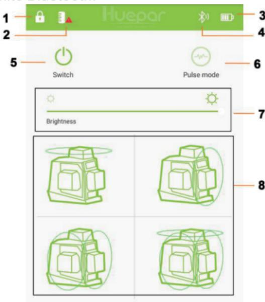
1. Stato del Blocco del Pendolo Intelligente: Quando lo strumento laser è acceso nella modalità manuale, l'icona 1 verrà visualizzata; quando è acceso nella modalità autolivellante, l'icona 1 scomparirà.
