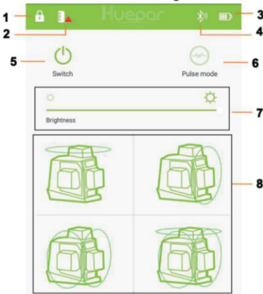
1. Intelligente Arretierung des Pendels: Wenn das Lasergerät im manuellen Modus eingeschaltet wird, wird das Symbol 1 angezeigt; Wenn Sie das Gerät im selbstnivellierenden Modus einschalten, Symbol 1 wird verschwinden.
